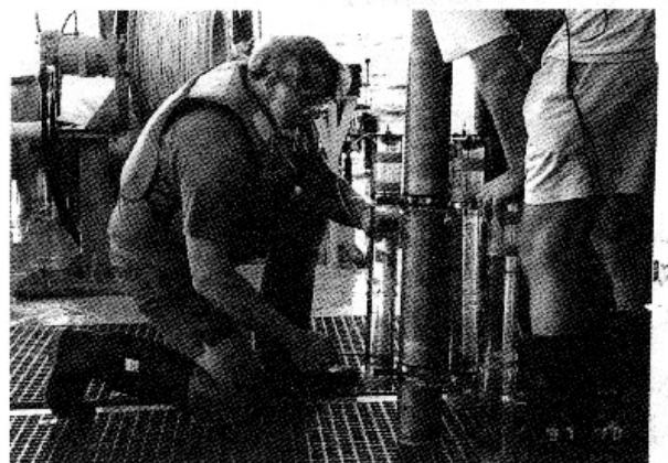
圖二 研究人員於執行「百慕達大西洋時序研究」例行航次,準備施放研發中之新型「沈降顆粒收集器」。
