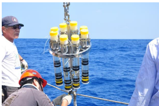
圖 2.2、漂浮式沉積物收集器
