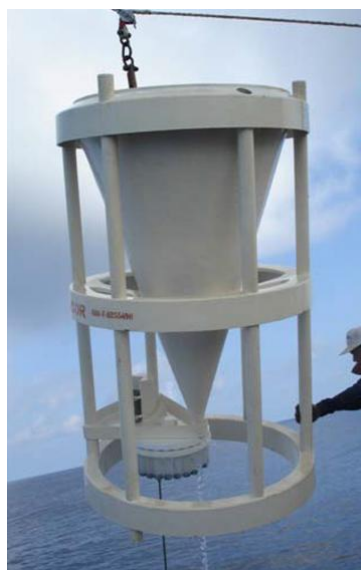
圖 2.3、錨碇式沉積物收集器
